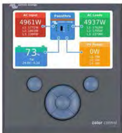
Color Control Panel, mit Anzeige eines PV-Systems
