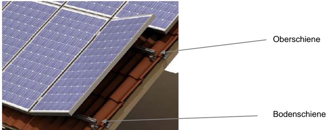
Zuerst ist herauszufinden, dass die Fliesen an der Stelle der Haken entspricht. Die Klammern müssen vertikal und horizontal genau ausgerichtet werden (vergleiche Abbildung unten). Der horizontale Abstand zwischen den Halterungen hängt von dem Raum zwischen den Dachsparren. Es ist im Allgemeinen zwischen 60 und 80 cm. Der vertikale Abstand zwischen zwei Schienen sollten etwa 1 Meter (typisch 3 Fliesen) sein.
