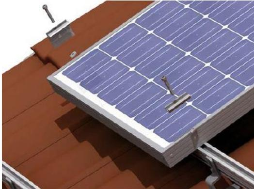
Positionieren Sie die Panels auf den Schienen und sichern jedes Panel mit den Klemmen (im Kit enthalten). Die Anschlussklemmen sind links und rechts in der Plattenreihe zu montieren. Die Zwischenklemmen werden zwischen den jeweiligen Panels montiert.
