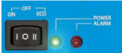
Notiz : Falls Sie den ECO-Modus einschalten und die grüne LED langsam blinkt, heisst das, dass der Verbraucher zu klein ist um den Wechselrichter im ECO-Modus zu betreiben (min. 15W). In diesem Fall können Sie den Wechselrichter auf ON stellen.
