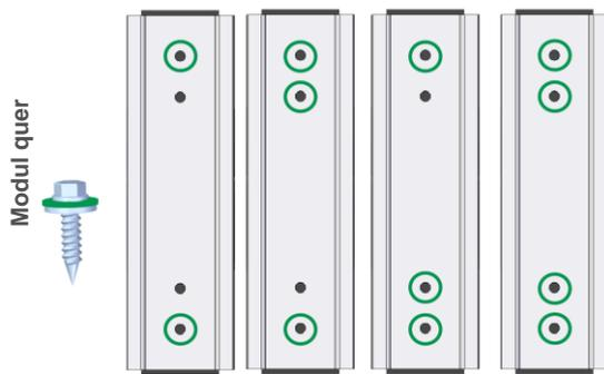
Die statische Berechnung in der Anlagenplanung legt die Anzahl der erforderlichen Befestigungsmittel für die Modulquermontage fest.
