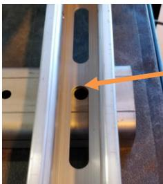
On placera la vis et l'écrou ici
