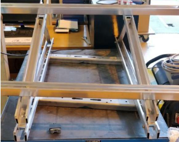
3. On fixe les barres de fixation du panneau comme montré sur la photo suivante :
