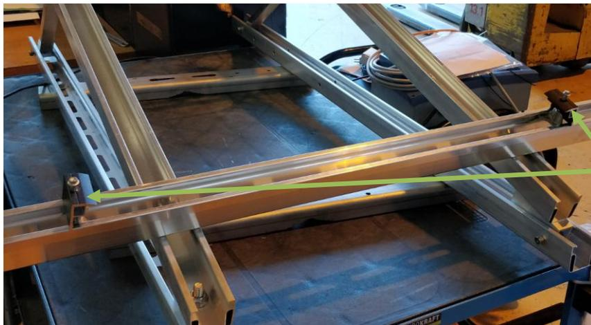
Befestigungsklammern für das Solarpaneel.
