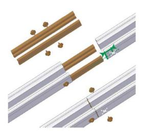
Setzen Sie die Verlängerung in die beiden Schienenteile.
