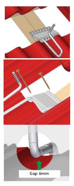
Die Befestigungswinkel werden auf den Sparren angebracht (oder den vertikalen Latten an den Sparren befestigt).
