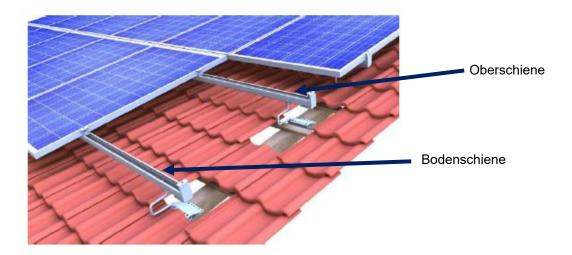
Zuerst ist herauszufinden, dass die Fliesen an der Stelle der Haken entspricht. Die Klammern müssen vertikal und horizontal genau ausgerichtet werden ( vergleiche Abbildung unten ). Der horizontale Abstand zwischen den Halterungen hängt von dem Raum zwischen den Dachsparren. Es ist im Allgemeinen zwischen 60 und 80 cm. Der vertikale Abstand zwischen zwei Schienen sollten etwa 1 Meter (typisch 3 Fliesen) sein.
