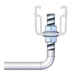
Sobald alle Hacken fixiert sind werden die horizontalen Schienen mit den vorgesehenen Schrauben angebracht. Jeder Hacken muss an der Schiene fixiert werden.
