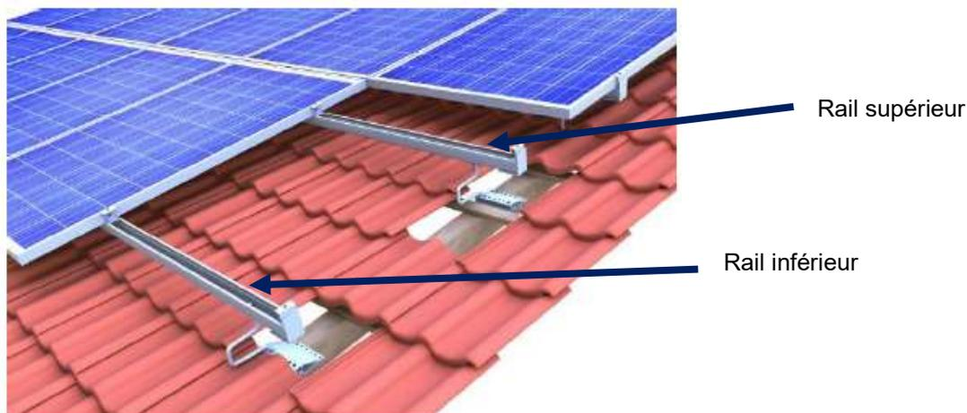
Tout d'abord, découvrez les tuiles correspondant à l'emplacement des crochets de fixation. Les crochets doivent être alignés au mieux verticalement et horizontalement (c.f. schéma ci-dessous). La distance horizontale entre les crochets dépend de l'espace entre les chevrons. Il est généralement compris entre 60 et 80 cm. La distance verticale entre deux rails doit être d'environ 1 mètre (généralement 3 tuiles).
