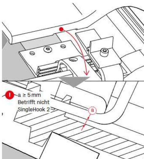
En fonction des modèles de tuiles, il peut arriver de devoir tailler la tuile supérieure et/ou inférieure à l'aide d'une meule à disque. Cette coupe permettra la bonne mise en place de la tuile supérieure. Laissez un jeu entre 1 et 5 mm entre la tuile inférieure et le crochet.
