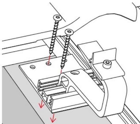
Les crochets de fixation se montent sur le chevron (ou sur la lambourde verticale fixée sur le chevron).
