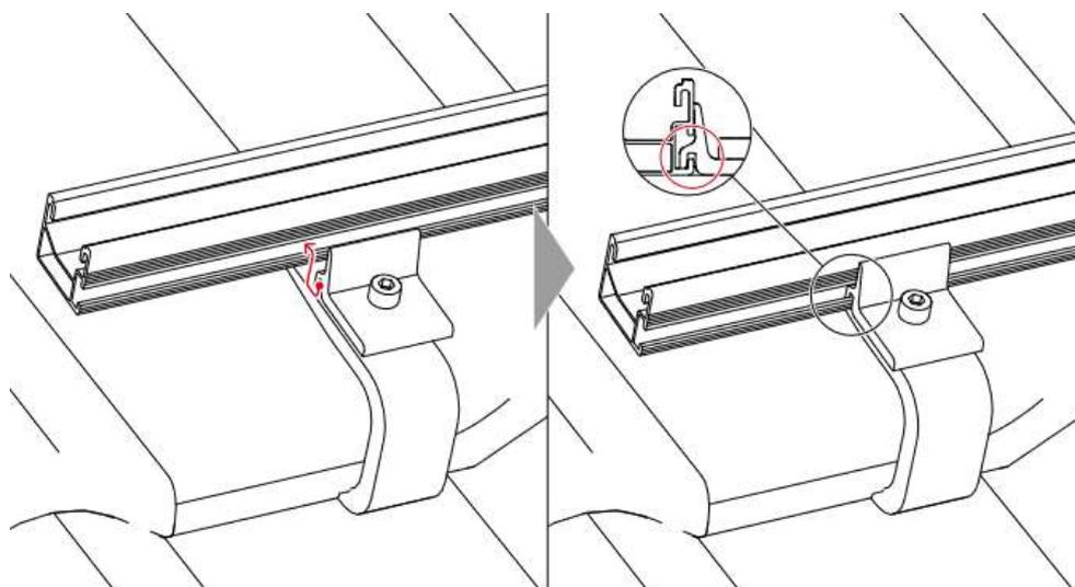
Une fois tous les crochets fixés, montez ensuite les rails horizontalement, au moyen des écrous fournis. Chaque crochet doit être fixé au rail.
