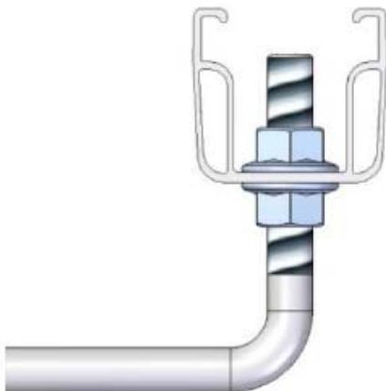
Sobald alle Hacken fixiert sind werden die horizontalen Schienen mit den vorgesehenen Schrauben angebracht. Jeder Hacken muss an der Schiene fixiert werden.
