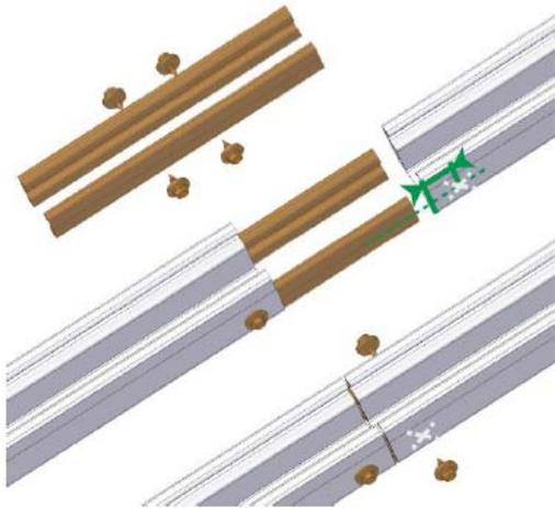
Setzen Sie die Verlängerung in die beiden Schienenteile.
