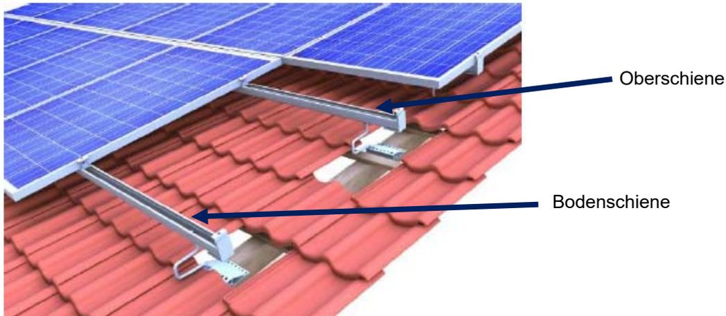
Zuerst ist herauszufinden, dass die Fliesen an der Stelle der Haken entspricht. Die Klammern müssen vertikal und horizontal genau ausgerichtet werden (vergleiche Abbildung unten). Der horizontale Abstand zwischen den Halterungen hängt von dem Raum zwischen den Dachsparren. Es ist im Allgemeinen zwischen 60 und 80 cm. Der vertikale Abstand zwischen zwei Schienen sollten etwa 1 Meter (typisch 3 Fliesen) sein.
