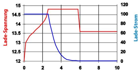
Bild 3: Dreistufen-Ladekennlinie
