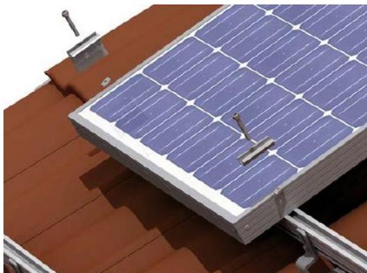
Positionnez le panneau sur les rails et fixez chaque panneau au moyen des pinces fournies dans le kit. Les pinces terminales se montent à l'extrême gauche et à l'extrême droite de la rangée de panneau. Les pinces intermédiaires fixent les panneaux deux à deux.
