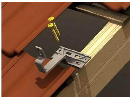
Les crochets de fixation se montent sur le chevron (ou sur la lambourde verticale fixée sur le chevron).
